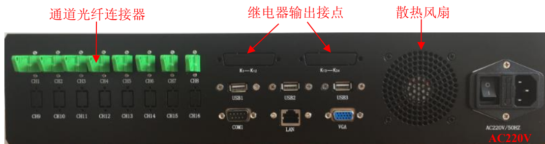
图 2.4 分布式光纤温度在线监测主机后面板接口示意图
