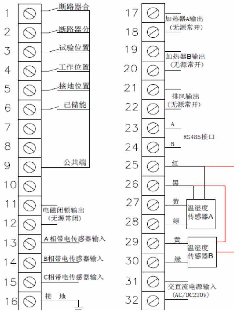
注意: 在对开关柜一次系统做耐压试验时, 如试验电压超过额定电压, 请将本装置 13、14、15、16 号端子拔出并短接。
