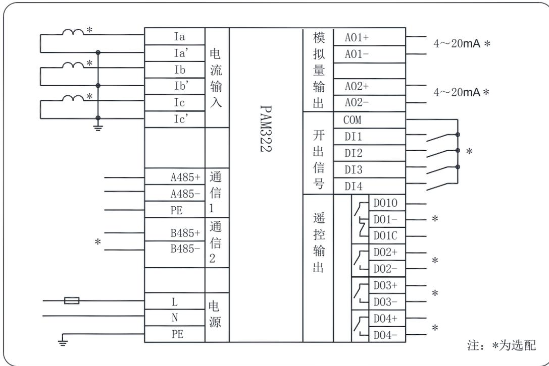
图二： 三相电流表接线方式
