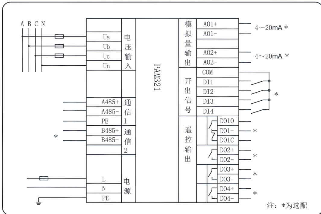
图一： 三相电压表接线方式
