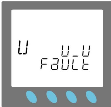
U\_U 欠压报警动作，表示 三相电压均小于设定值，保护动作，出口继电器动作
